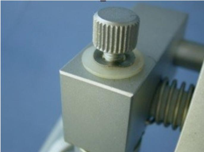
6b: Die gewellte Unterlegscheibe unter der Schraube ist wichtig. Sie bremst die Drehbewegung (The corrugated washer under the screw is important. It weakens the rotary motion).
