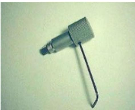
Bei Instrumenten ohne 6a wird der Trieb ausgebaut und die Federscheibe neu gespannt (In instruments without 6a will be expanded the drive and the spring tension adjusted).
