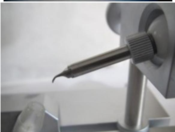
Stachelgreifer sauber halten und Desinfektion mit Alkohol (Pressuregrip keep clean with alcohol).
