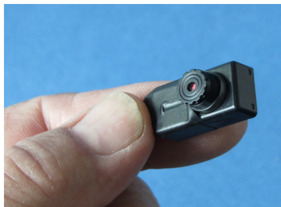
Abb. 1: Micro-Kamera mit hoher Auflösung und eingebautem Mikrofon
