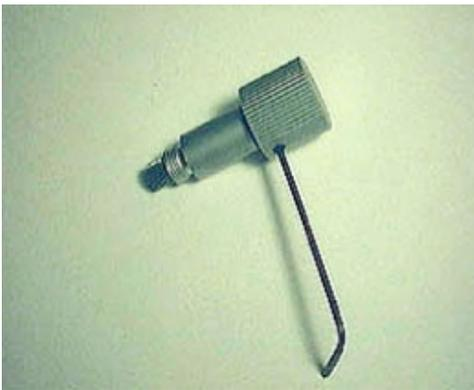
Bei alten Instrumenten ohne 6a wird der Trieb ausgebaut und die Federscheibe neu gespannt (In old instruments without 6a will be expanded the drive and the spring tension adjusted).
