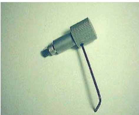
6a: An dieser Mutter kann der Trieb nachjustiert werden (At this nut will be adjust the drive).
