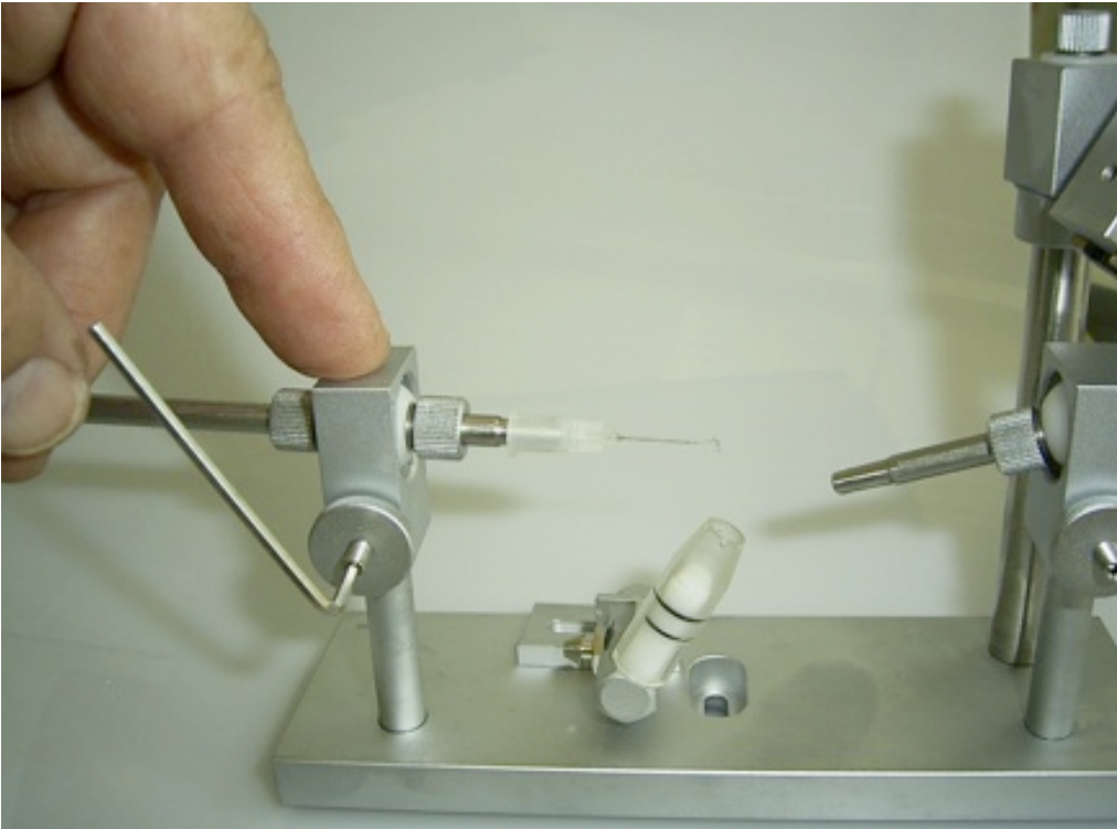
Einstellung der Kugeln bei Gerät 1.04 (Adjust the balls for the instrument 1.04).
