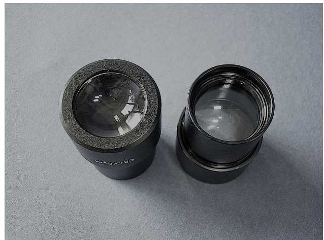
Meßokular 10x23 (Art.-Nr. 2.42) mit Winkelskala für Stereomikroskop K 400.
