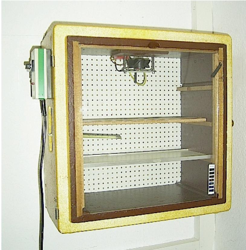
Das Temperaturoptimum für die Ei- und Madenentwicklung liegt im Bereich von 32-35 Grad C. Die Brutbox wird auf 33,4 - 34 Grad eingestellt. Da die gewünschte Temperatur sich erst langsam einpendelt und sich anfangs immer noch etwas erhöht, sollte schon ein Tag vorher die Brutbox in Betrieb genommen und eingeregelt werden. Die Brutbox ist an einem Ort aufzustellen, wo keine großen Schwankungen der Tagestemperaturen auftreten.
