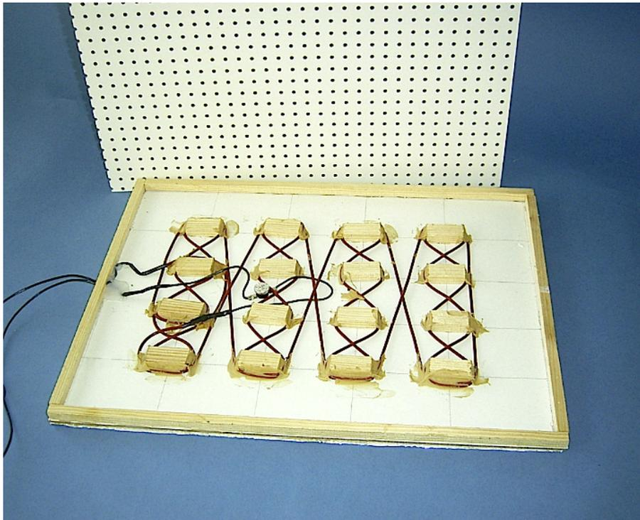
Für den Heizboden mit einer Leistung von etwa 60-80 Watt wird ebenso die Pappe in 3 mm Dicke verwendet. Darauf werden Abstandsklötzchen geklebt. Diese werden von der Rückseite zusätzlich angenagelt. Die Heizschnur wird zwischen den Holzstückchen verlegt. Sie wurden hier mit lösungsmittelfreiem FlieBenkleber fixiert, was auch mit der HeiBklebepistole erledigt werden kann.
